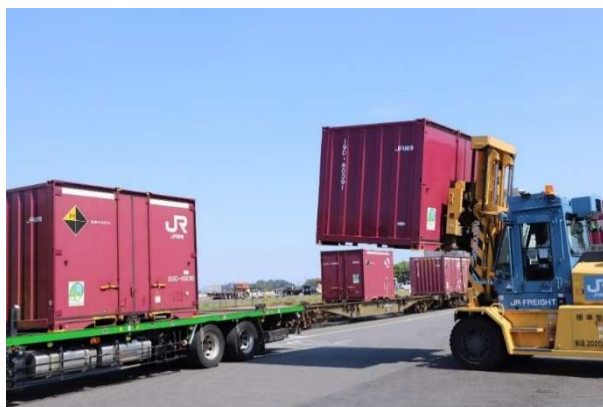
貨物ターミナル駅で貨物列車からトラックに鉄道コンテナを積み替え
